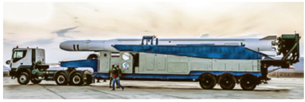
قاصد از روی یک پرتابگر متحرک و بدون نیاز به سکوی ثابت پرتاب می‌شود
