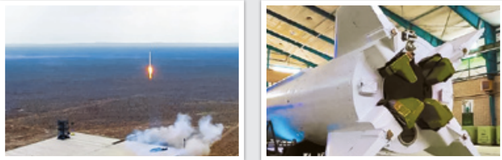
پالک‌های کنترلی نصب‌شده در خروجی موتور سوخت مایع در مرحله اول ماهواره بر قاصد
