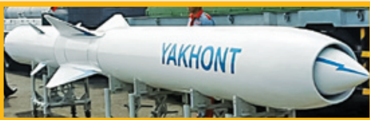
موشک کروز فراصوت مشهور یاخونت (اونیکس) مجهز به موتور رم جت
