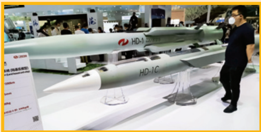
دو نمونه از موشک‌های کروز فراصوت چینی مجهز به موتور رم جت
