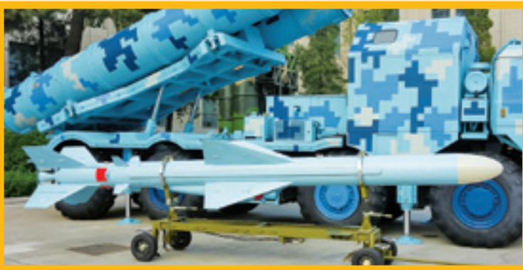
موشک کروز ضد کشتی C-803 که در فاز نهایی پرواز به سرعت فراصوت می‌رسد
