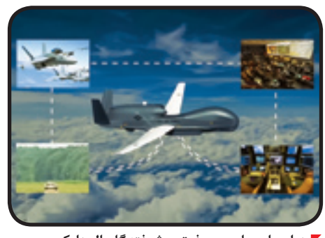
هواپیمای جاسوسی فوق پیشرفته گلوبال هاوک که به عنوان نقطه ارتباطی سایر تجهیزات هم عمل می‌کند
