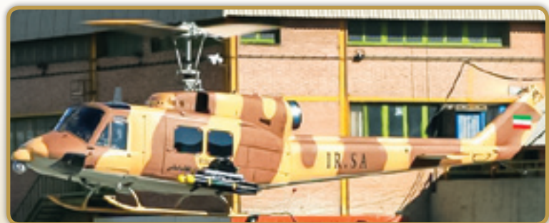
موشک قائم ۱۱۴ روی بالگرد ۲۱۴ هوانیروز سپاه، سامانه شناسایی و هدف گیری اپتیکی جلوی دماغه بالگرد مشاهده می شود
