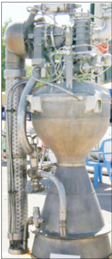
موتور سوخت مایع موشک شهاب ۳
